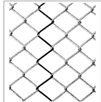
Para unir dos segmentos de malla, se usa un eslabón de la misma, entrelazándolo en espiral entre los vértices.
