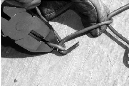
1. Abra las puntas del alambre del borde del rollo en los dos extremos
